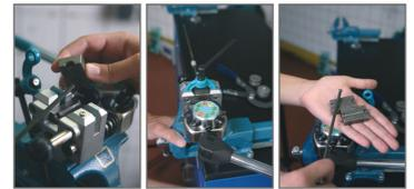
Mit wenigen einfachen Arbeitsschritten unter 2 Min. zum perfekt gebördelten Rohr
